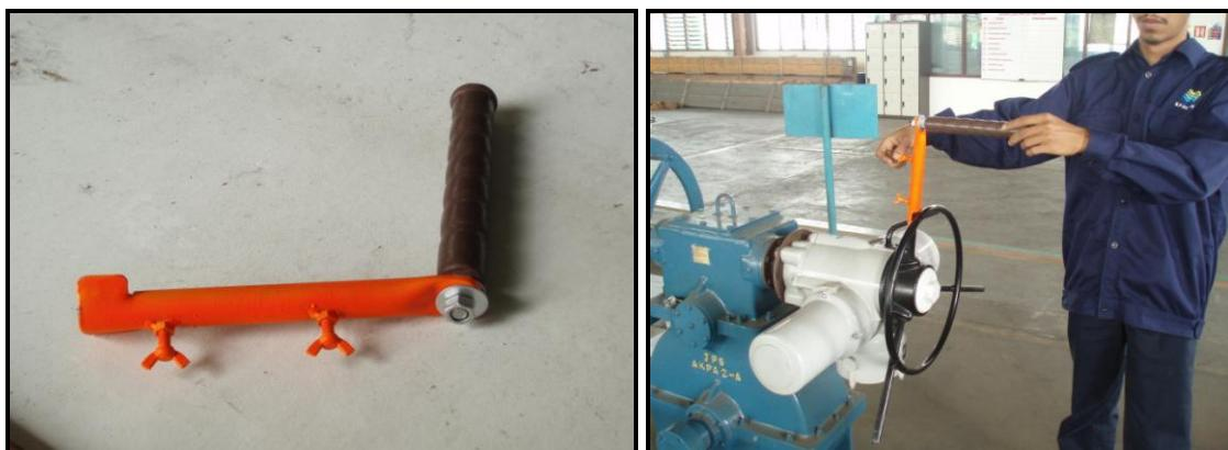
Rajah 4: *Smart Handle* untuk *actuator* jenama Rotork.
